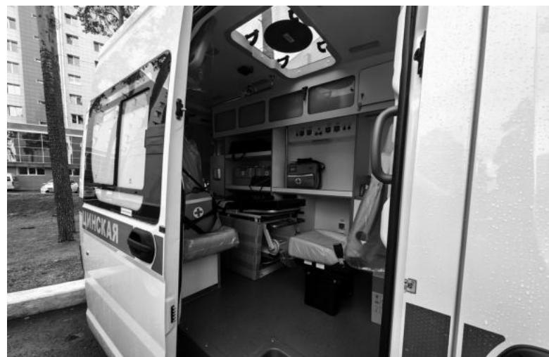
Карты скорой помощи класса «В» – технологичные медицинские транспортные средства, которые оснащены широким спектром оборудования. В них есть автоматический дефибриллятор, трёхканальный электроэнцефалограф, портативный аппарат искусственной вентиляции лёгких и так далее. Всё это делает автомобиль универсальным помощником медиков в самых сложных ситуациях. Кроме того, четыре из 26 новых машин оснащены полным
